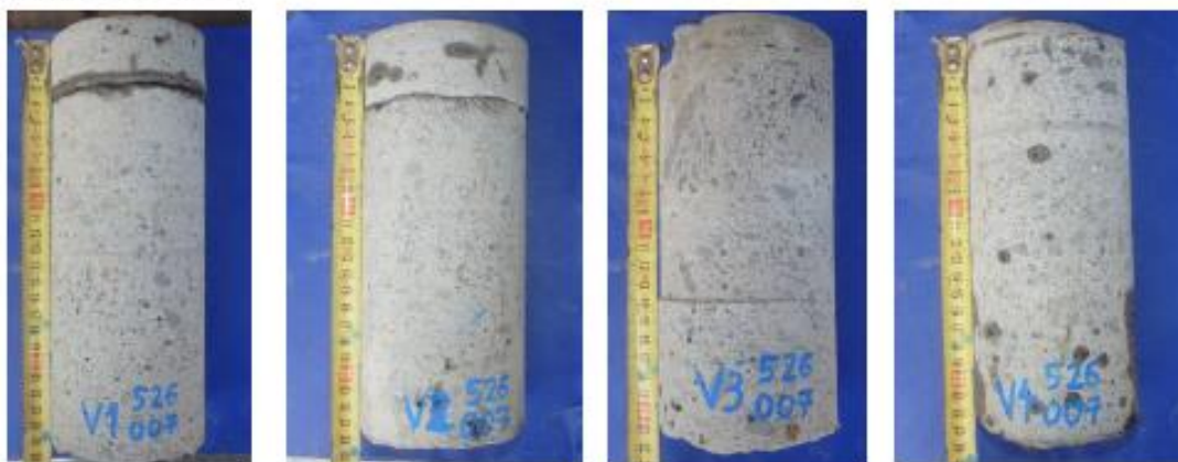
Obr. 57 Odobraté jadrové vývrtky – nosná konštrukcia
